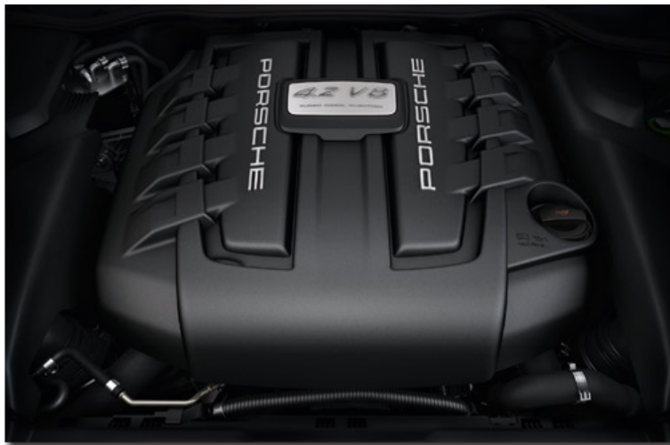
Der 4,2 Liter große Achtzylindermotor mit Biturboaufladung leistet 281 kW (382 PS)
