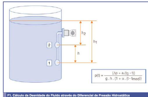
F1. Cálculo da Densidade do Fluido através do Diferencial de Pressão Hidrostática
