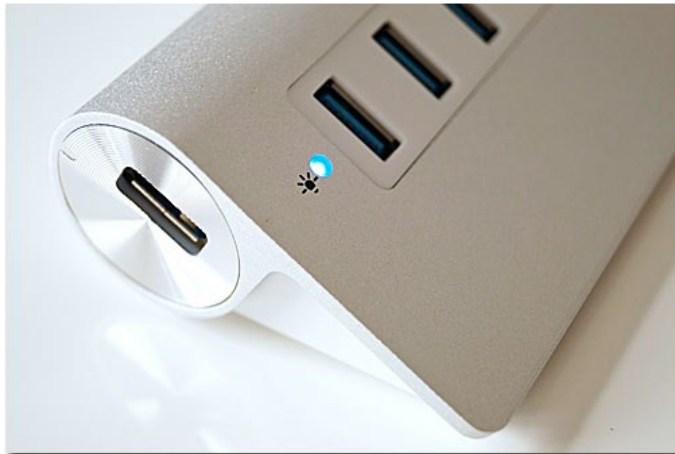
Die blaue LED signalisiert die Spannungsversorgung durch das externe Netzteil
