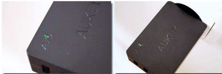
Die grüne LED signalisiert den Betriebsstatus
