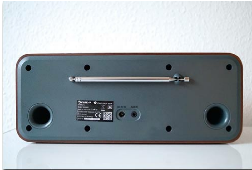
Die Rückseite mit Teleskopantenne sowie Eingang Stromversorgung und AUX
