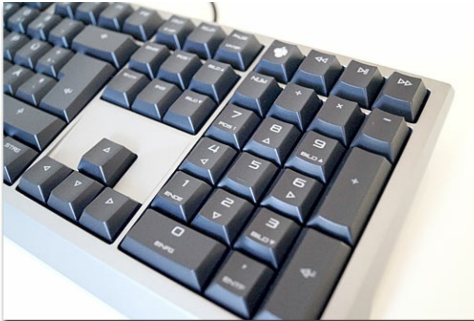
Die Auslösung eines Befehls erfolgt bei etwa halben Tastenhub (2mm)
