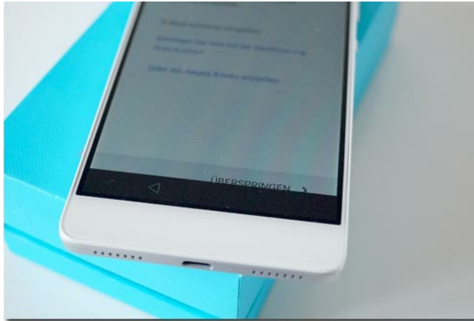
Das Honor 7 verfügt trotz zwei Lochgruppen nicht über Stereo-Lautsprecher
