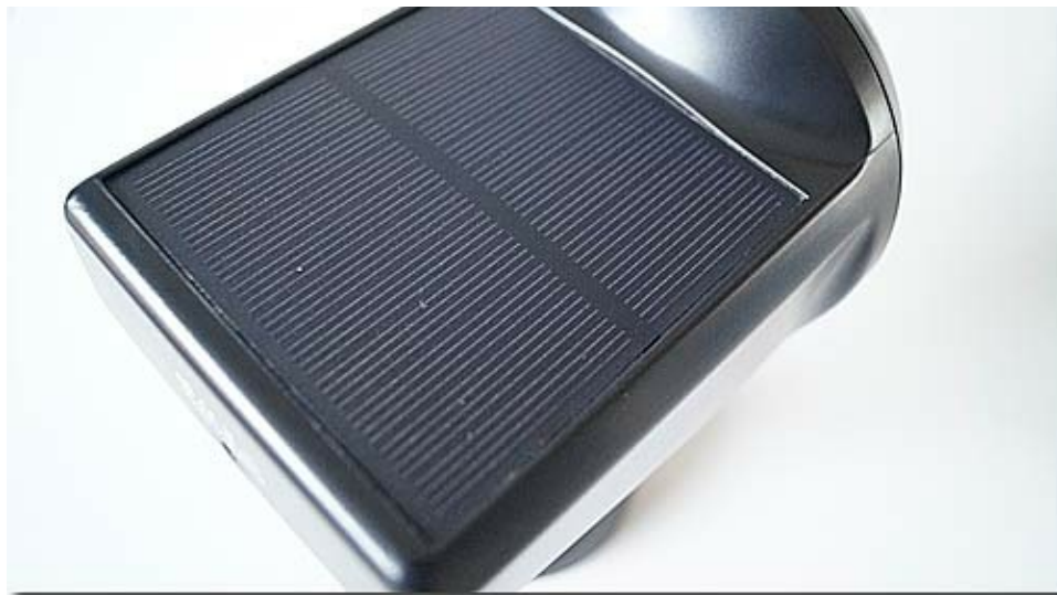
Das Solarmodul auf der Oberseite des Strahlers
