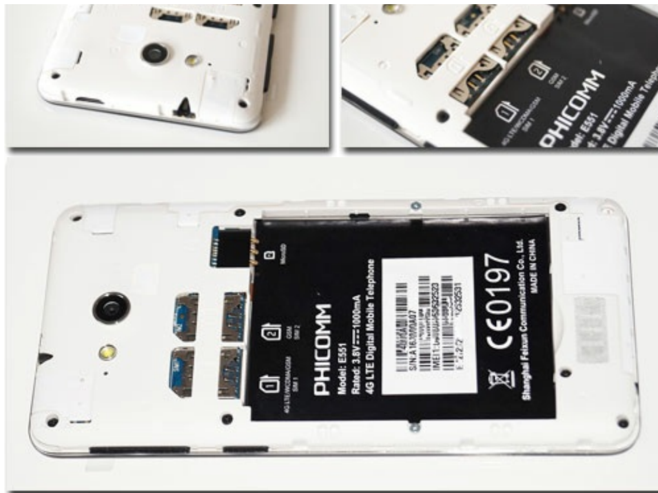
Zwei Steckplätze für SIM-Karten und ein Speicherport für eine MicroSD-Karte sowie Wechselkarte
