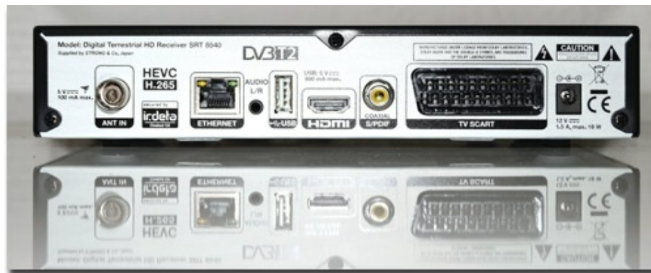
Die Anschlüsse auf der Rückseite
