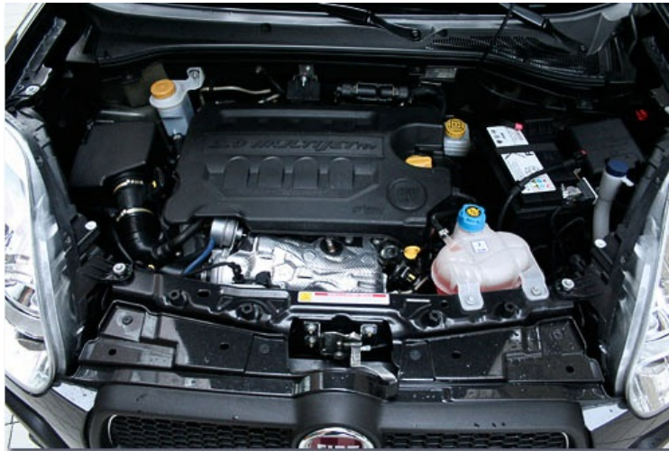
Der 2-Liter Multijet-Turbodiesel leistet 135 Ps und erfüllt die Euro 5 Norm
