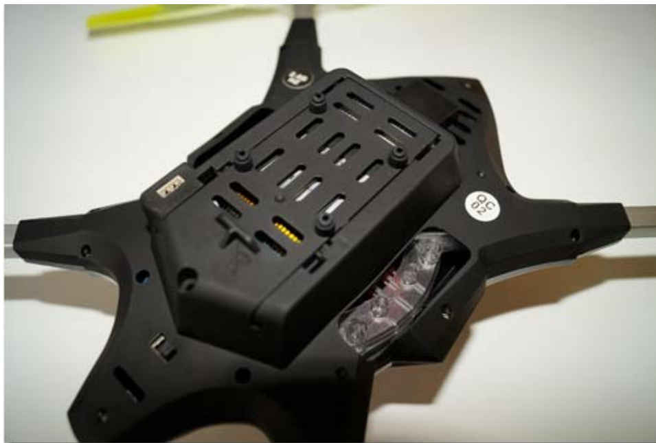
Dronen-Unterseite. Hinter der Schiebeabdeckung befindet sich die Elektronik nebst Akku mit 1.200mAh für knapp 10 Minuten Fliegvergnügen
