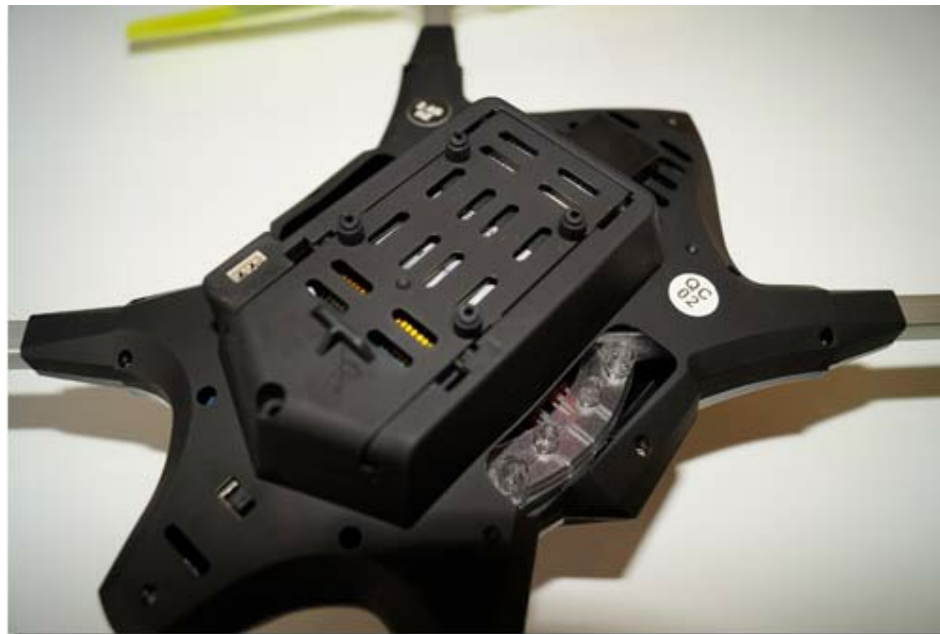
Dronen-Unterseite. Hinter der Schiebeabdeckung befindet sich die Elektronik nebst Akku mit 1.200 mAh für knapp 10 Minuten Flügvergnügen
