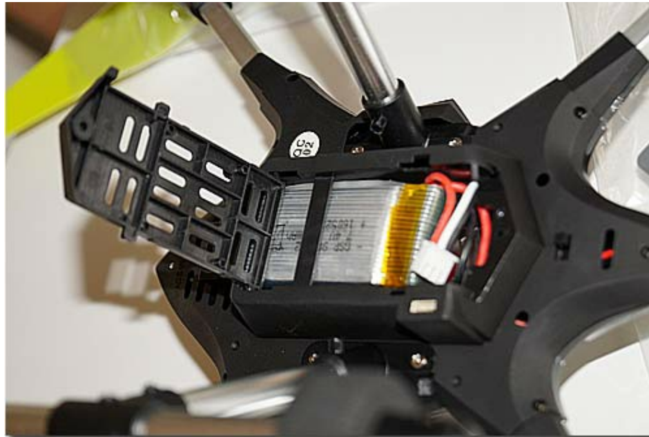
Der integrierte Akku (1.200 mAh)
