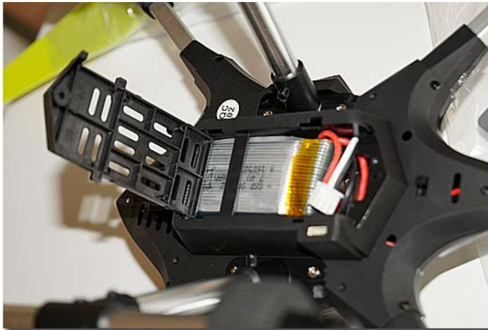
Der integrierte Akku (1.200 mAh)
