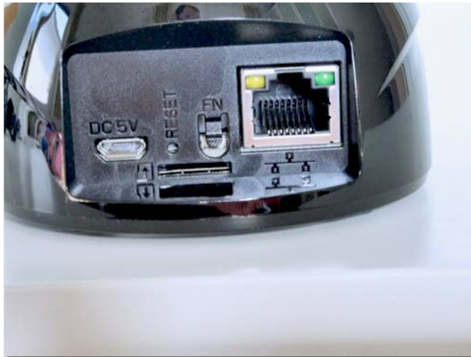
Auf der Rückseite befinden sich die Anschlüsse sowie MicroSD-Card-Schacht
