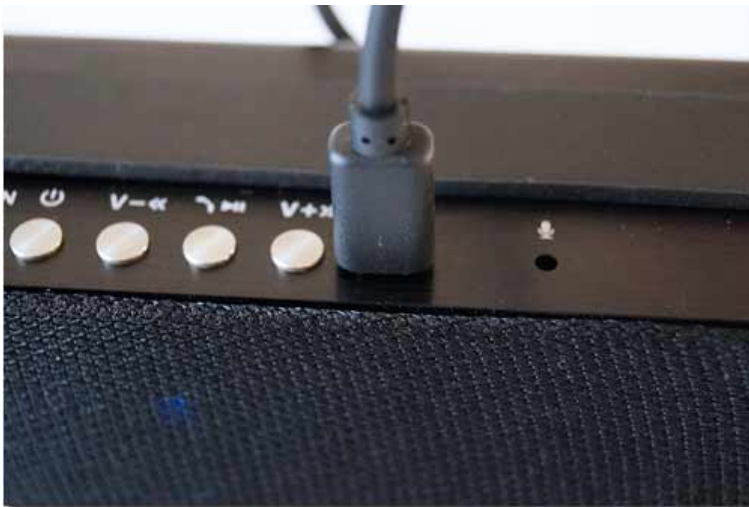
Die Micro-USB-Buchse dient nur dem Aufladen; Rechts daneben ist das Mikrofon für die Freisprechfunktion integriert
