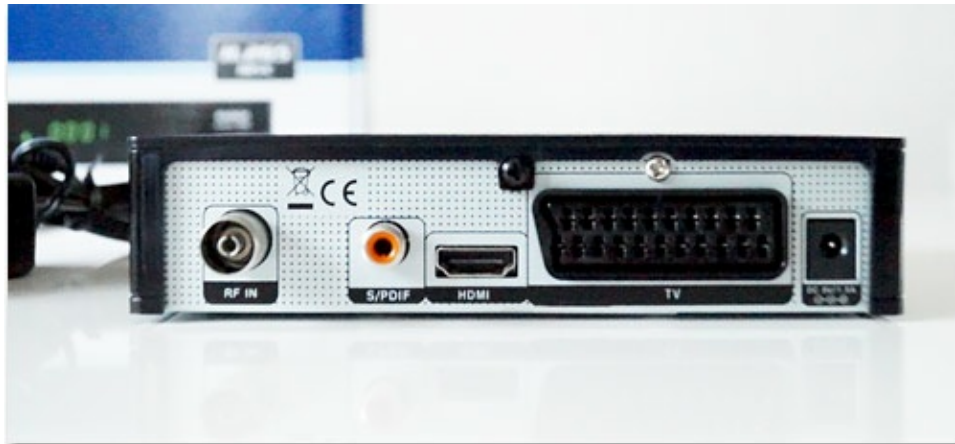
Die Anschlüsse an der Rückseite: Antenneneingang, S/Pdif (digital-audio), HDMI sowie Scart und DC-In
