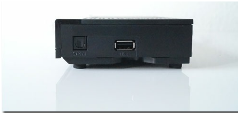
Der seitliche USB-Port (USB 2.0) für USB-Stick oder portable HDD sowie Digital Audio (TOS-Link)
