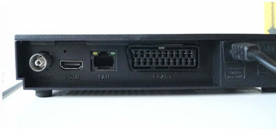
Die Anschlüsse (Antenne, HDMI, Netzwerk-Port und Euro-Scart). Der USB-Port ist an der Seite platziert
